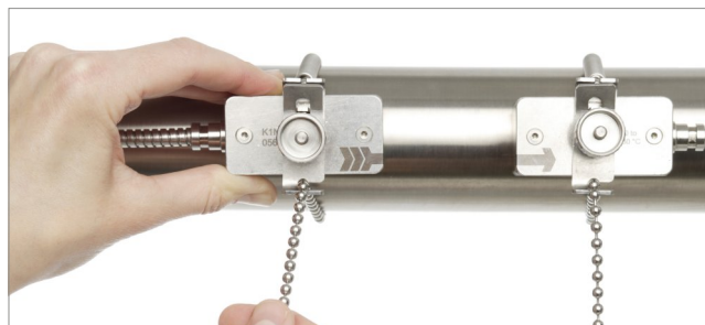
3. Montages des capteurs avec chaînes et clips
