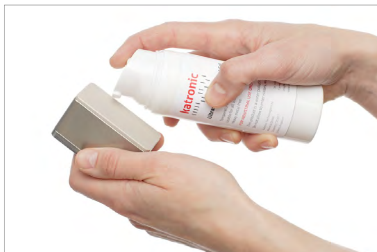
Illustration 8 : Application de la pâte de couplage ultrasonique sur la tête du capteur
