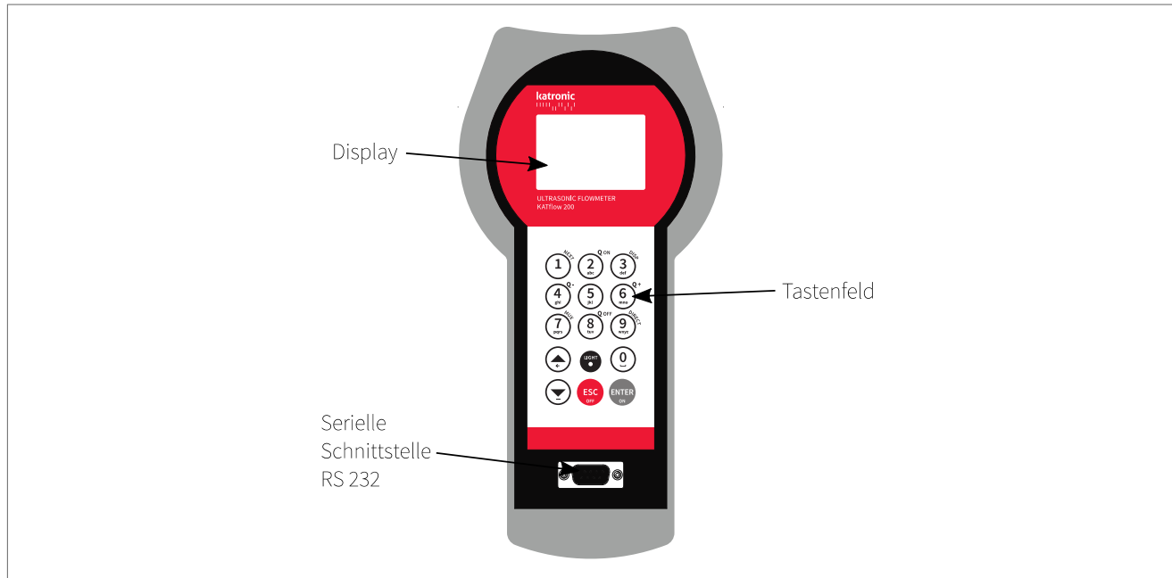
Abb. 12: Bedienfeld und Display KATflow 200
