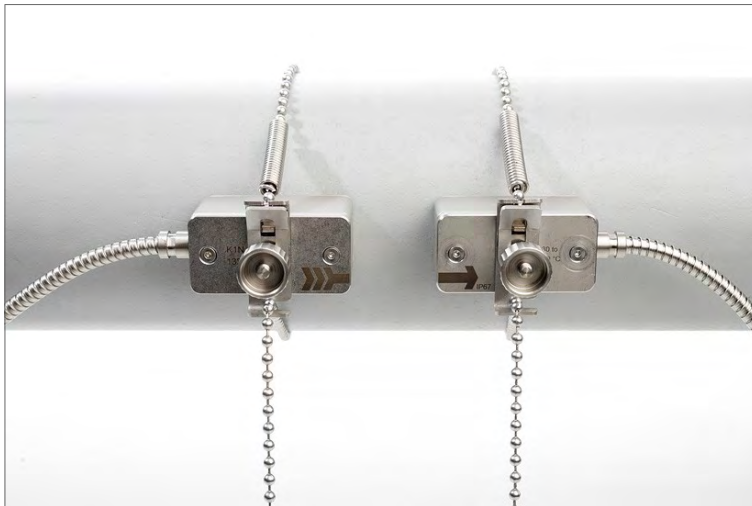
Illustration 8: Positionnement correct des capteurs
