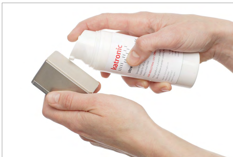
Illustration 7: Application d'un gel de couplage acoustique
