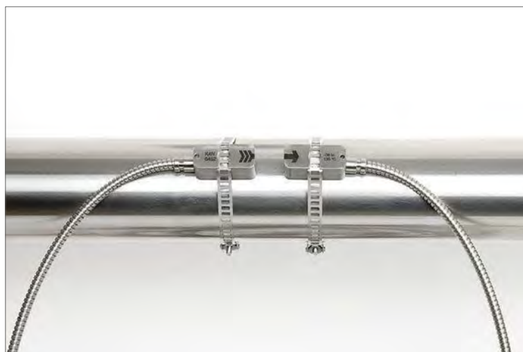
Image 10 : Montage du capteur avec sangles de tension
