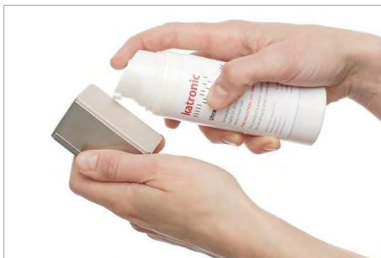
Image 8 : Application d'un gel de couplage acoustique
