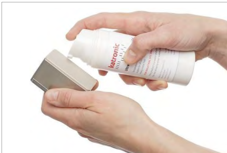
Image 8 : Application du gel de couplage acoustique
