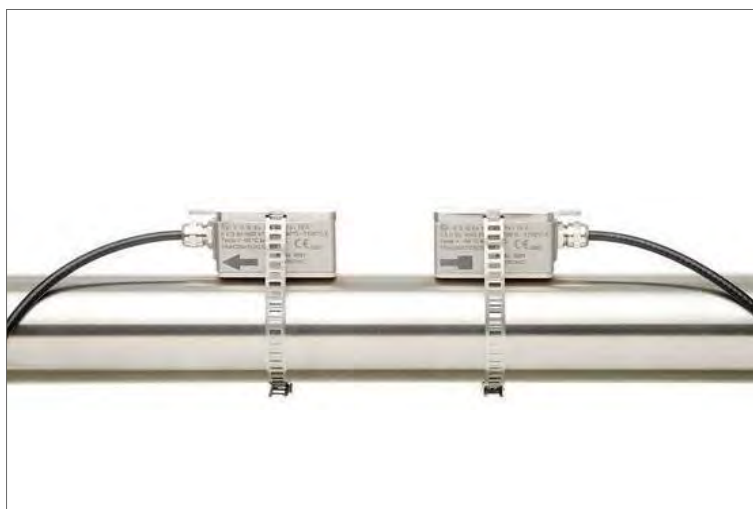
Image 9 : Positionnement correct des capteurs
