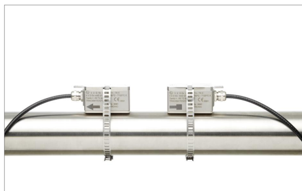
Wandlerpaar mit Metallbändern am Rohr befestigt
